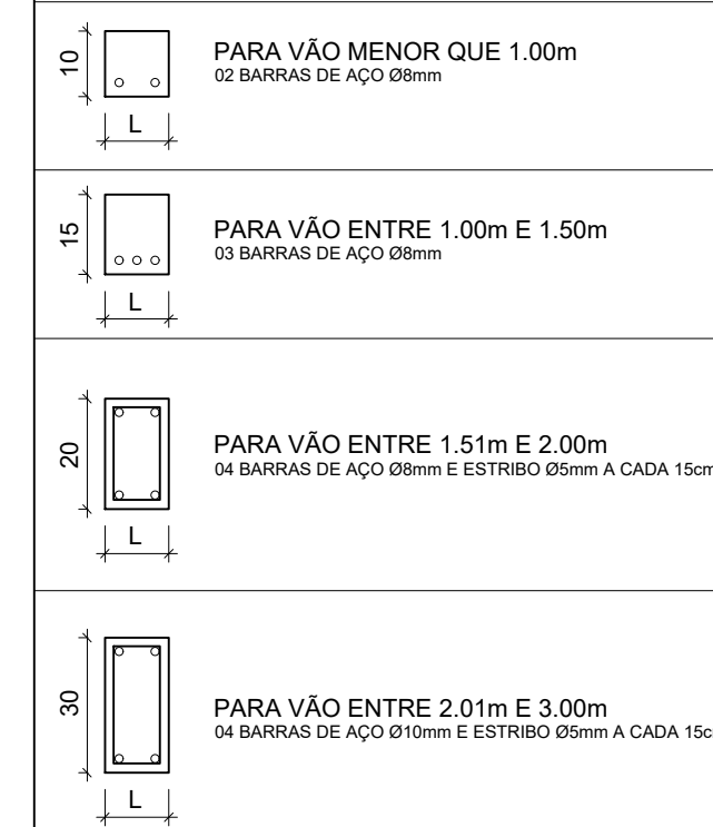
DETALHE UTILIZAR VERGAS E CONTRA VERGAS EM JANELAS E PORTAS
